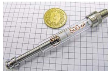
El émbolo de cristal de esta jeringa de microlitro se completa con varios componentes de gran precisión hechos de metal y plástico.
