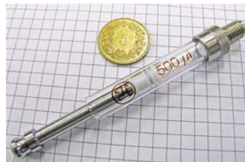
O frasco de vidro da seringa de microlitros é complementado por vários componentes de alta precisão feitos de metal e plástico.
