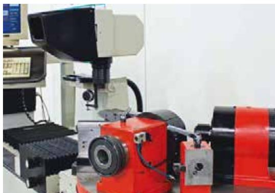
As ferramentas que foram precisamente pré-reguladas na estação de regulagem podem então ser carregadas e reguladas na máquina em apenas alguns passos simples.
