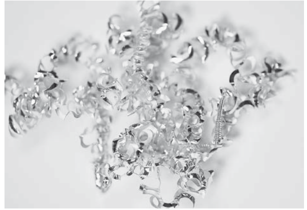
非高效断屑循环的切屑
