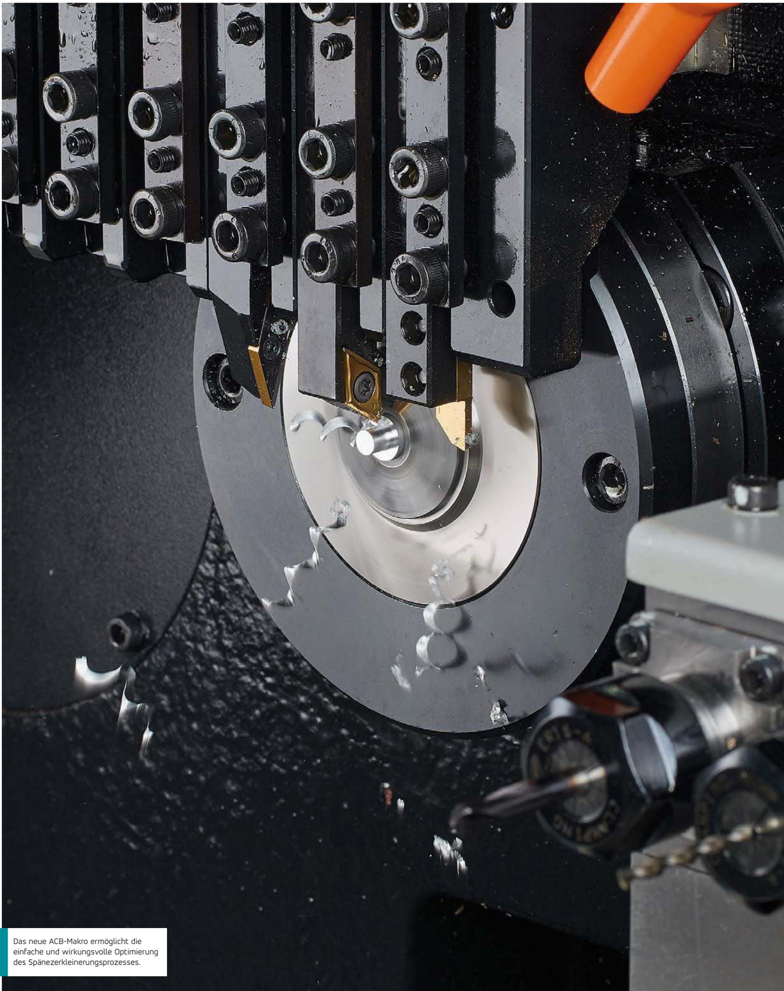
Das neue ACB-Makro ermöglicht die einfache und wirkungsvolle Optimierung des Spänezerkleinerungsprozesses.
