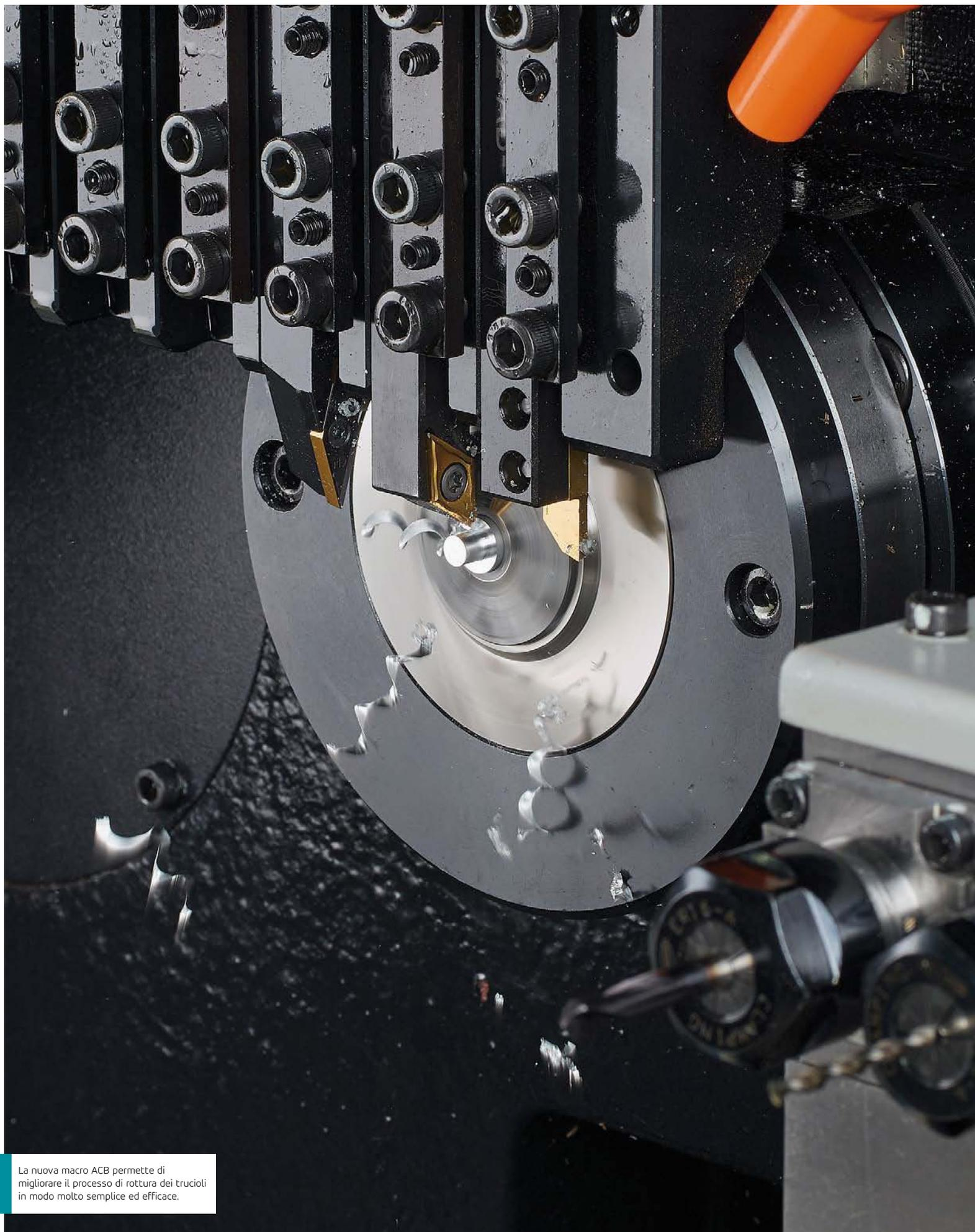
La nuova macro ACB permette di migliorare il processo di rottura dei trucioli in modo molto semplice ed efficace.
