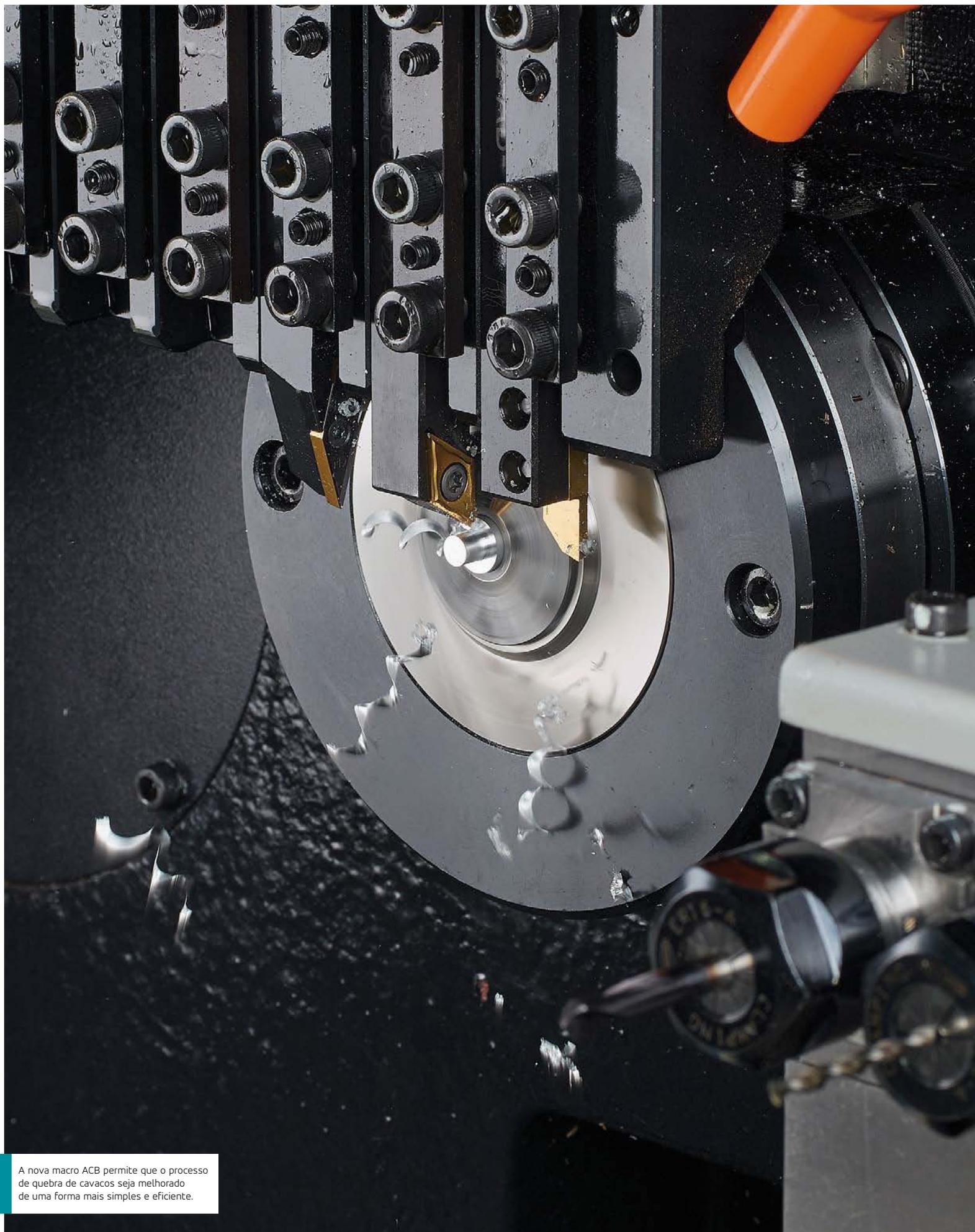
A nova macro ACB permite que o processo de quebra de cavacos seja melhorado de uma forma mais simples e eficiente.
