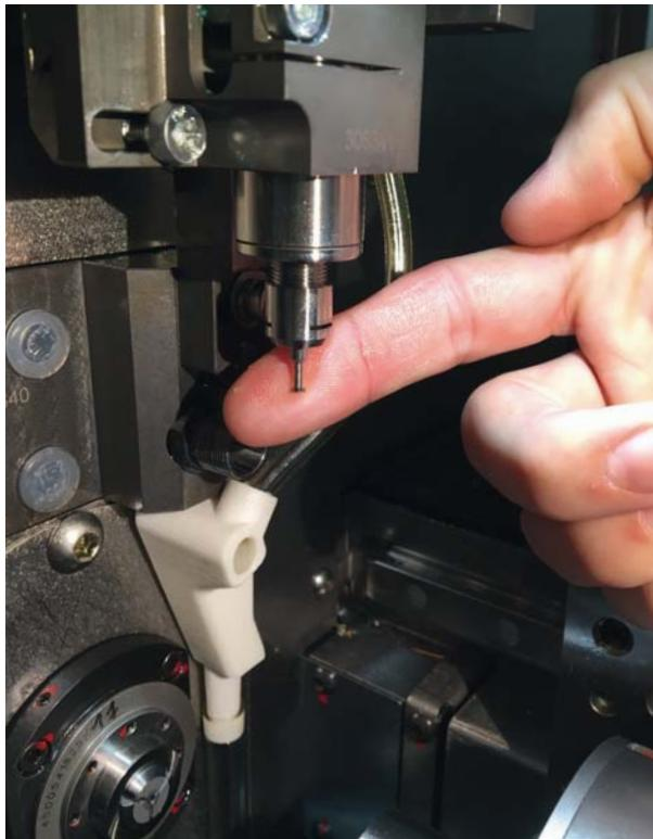
Weiss解释说：“我们的手表中所有4 mm以下的车削零件，都是有由SwissNano机床加工制造的。”“我们还在该机床上执行滚齿加工。一年生产两千块手表的量并不是很多。SwissNano机床可以在几个小时内加工2000个小齿轮。但是，一旦我们将所有的部件都安装在一台机床上用于小批量生产，我们就可以根据需要购买另外的机床以满足发展需求。希望有一天，我们的车间里有50台这样的机床。”
