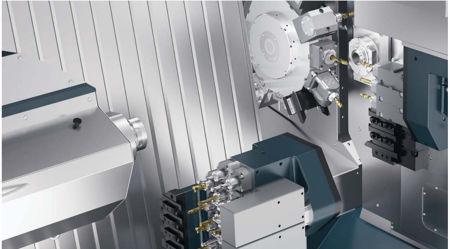
配备组合刀架和刀塔的型号可以带或不带B轴。
