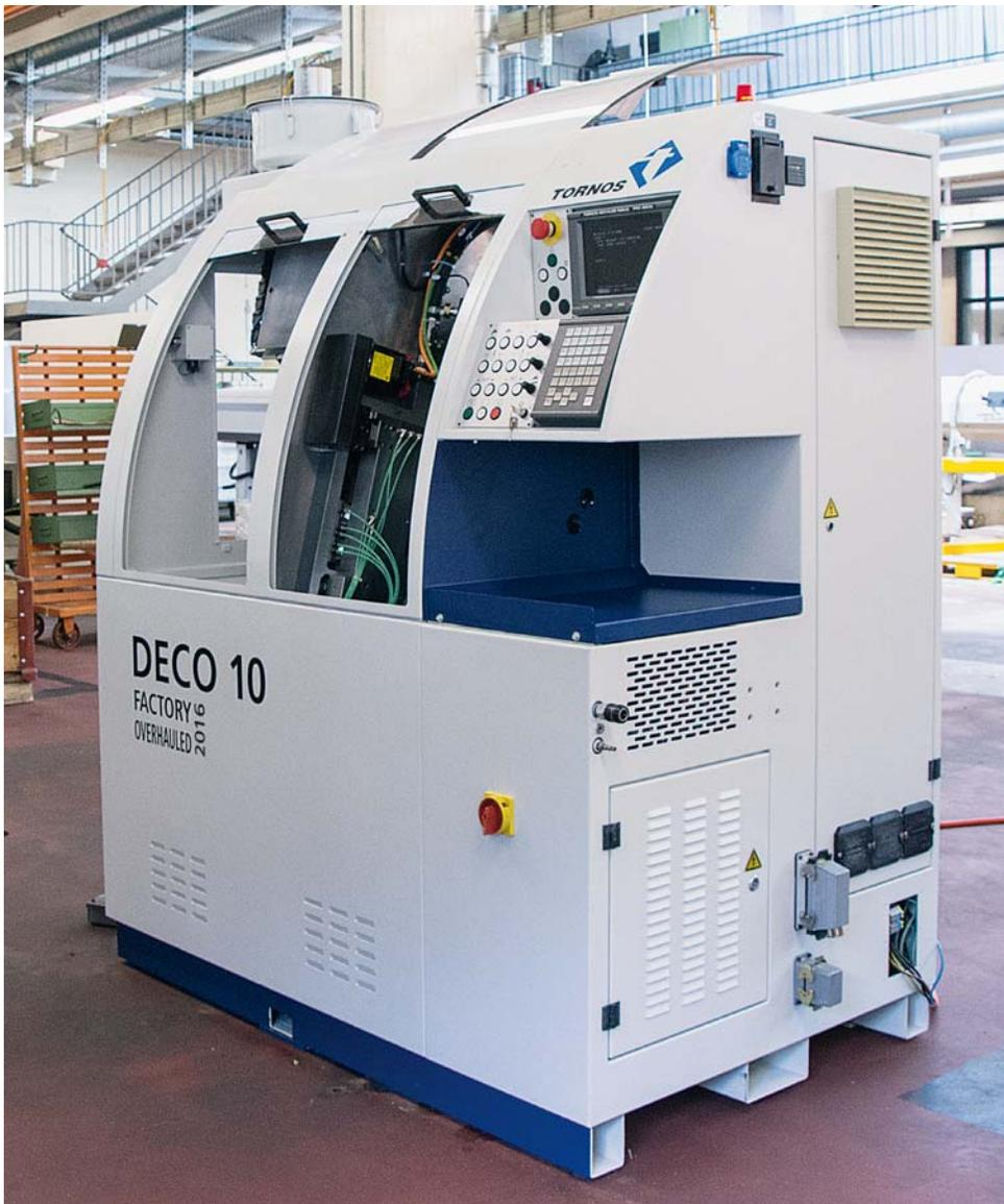
En caso de realizar una revisión general, la máquina se desmonta por completo y reacondiciona
