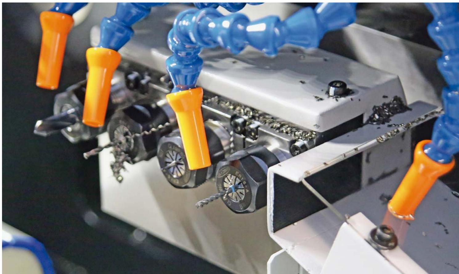
Le CT 20 dispose au total de 26 positions d'outil. Les quatre positions d'outil pour l'usinage au dos sont présentées ici. (photo: Klaus Vollrath)
