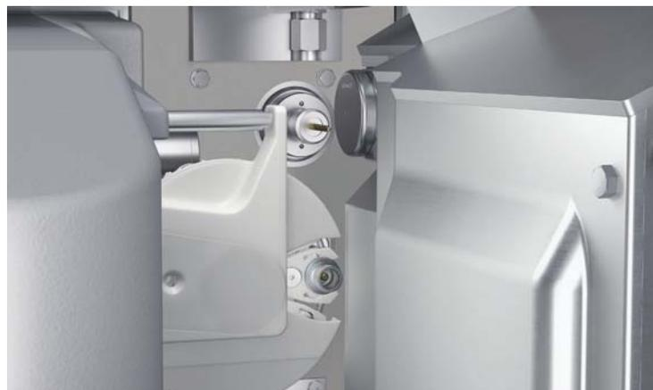
broches mécaniques ou des broches haute fréquence en fonction des besoins de l'usinage. La cinématique et les performances invitent à réaliser des pièces plus complexes. Qui dit pièces complexes, dit très souvent un nombre d'outils plus important. Certes, il est possible d'utiliser des outils de formes pour s'absoudre de certaines limitations, mais ce n'est pas toujours possible et la réalité économique ne permet pas à tous les coups ce genre d'exercice.
