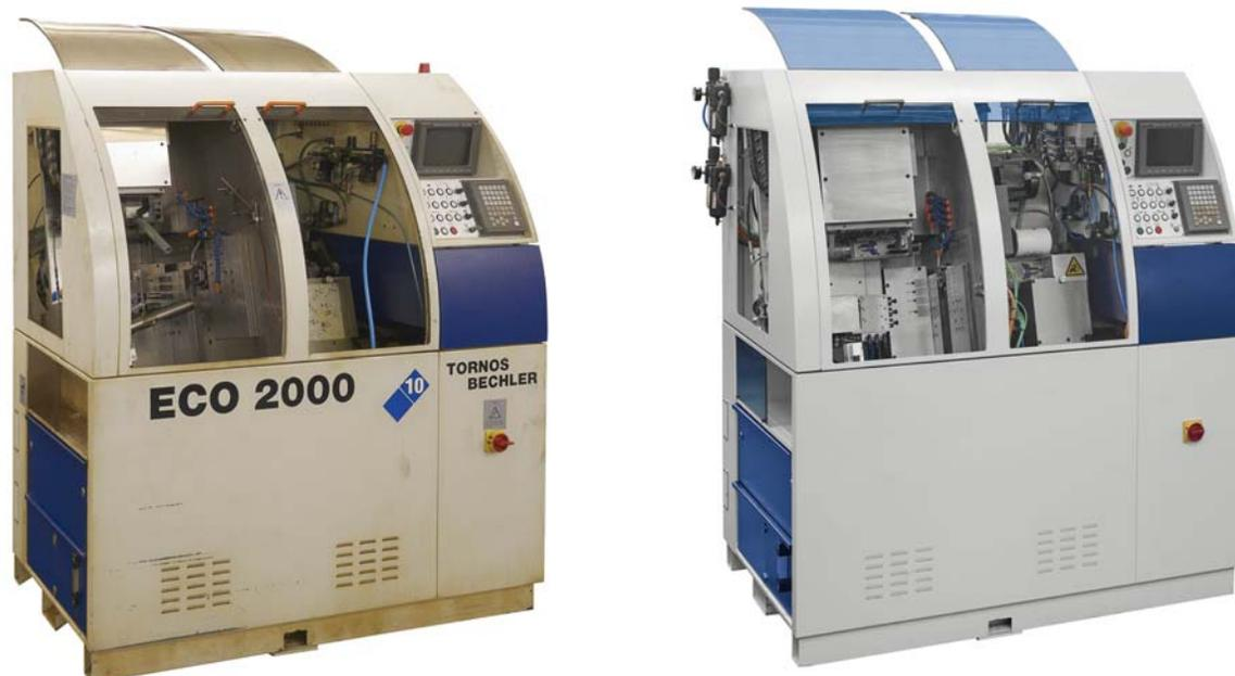
Dopo più di 80.000 ore di produzione, questa macchina Deco 10 viene sottoposta ad una revisione completa prima di essere proposta come macchina usata. Nonostante i segni del tempo siano ben visibili, la macchina lascerà la fabbrica di Moutier in uno stato quasi nuovo e continuerà a produrre per molti anni.
