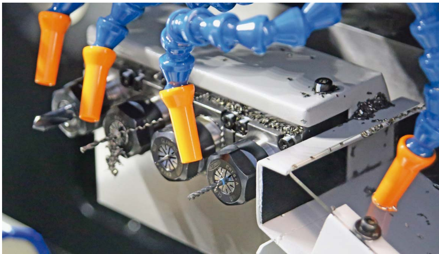
A CT 20 tem um total de 26 posições de ferramenta. Aqui são mostradas as quatro posições da ferramenta para usinagem traseira. (fotografia: Klaus Vollrath)
