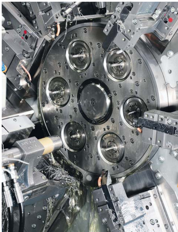
O envelope de trabalho da MultiSwiss com componentes automotivos em cada eixo.
