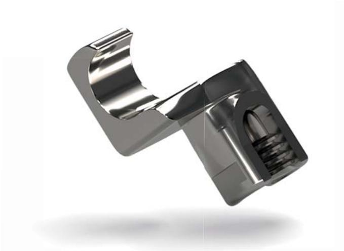
选择用于加工测试的第三个工件是椎间融合器，这个工件外形就像一个钩子一样，需要很多动力刀具。然而，该工件的材料由PEEK制成，PEEK是一种需要干式加工的材料，在加工时需要通过喷嘴提供压缩空气进行冷却。根据要执行的加工任务的要求，机床在加工过程中可以将冷空气进行冷却。正是在此，SwissDeco体现了其卓越的加工优势。实际上，这个工件选择在SwissDeco机床上加工是最理想的方式，部分原因是该机床还能够自动插入标记针销。对于这种类型的工件，我们专门研发了专用的自动上下料系统。当患者需要进行X光检查时，通过该针销可以使该工件在检测时被检测到。
