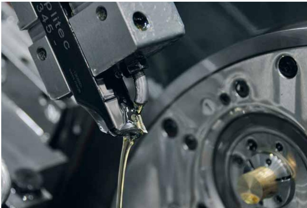
Der Werkzeughalter der Tornos MultiSwiss 6x14 weist neu eine Ölbohrung auf und leitet das Bearbeitungsfluid exakt an die vorderste Front: Zwischen die Werkzeugschneide und das Werkstück.
