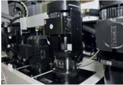
Für die leistungsfähige Ölversorgung wurde kein Aufwand gescheut. Gleich mehrere Pumpen fördern das für die Maschinenleistung zentrale Swisscut Ortho NF-X in verschiedenen Kreisläufen und Reinheitsklassen an die Schmierstellen.
