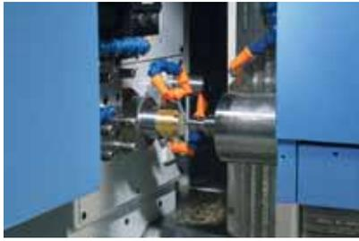
Blick auf die Hauptspindel: Das Bearbeitungszentrum ist bereit zur Bearbeitung der ersten Seite einer neuen Platine direkt auf der Stange.
