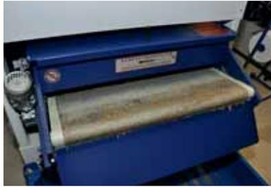
Un filtre à bande intégré filtre l'huile de coupe à 50 µ dans la plupart des cas. Le réservoir principal contient 880 litres d'huile de coupe. Un autre réservoir de 240 litres fournit aux paliers hydrostatiques une huile Ortho NF-X filtrée à 5 µ.
