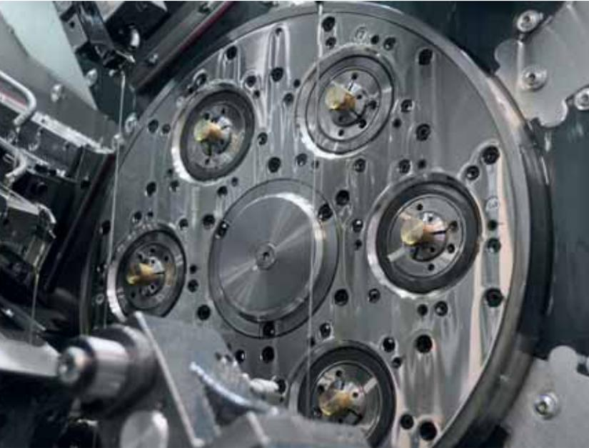
Le cœur de la machine: la zone d'usinage avec les 6 poupées mobiles. Grâce au concept multi-outil, il est possible de monter jusqu'à 18 outils différents sur la machine.
