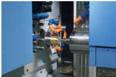
Regard sur la broche principale: la machine est prête à usiner la face une d'une nouvelle platine directement sur la barre.
