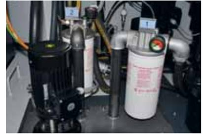
La MultiSwiss dispose d'emblée de deux filtres à huile fins. Grâce à un circuit bien étudié, il est possible de remplacer l'un ou l'autre des filtres pendant la marche, sans interruption de la production. La pression de l'huile dans la machine peut atteindre 80 bar.
