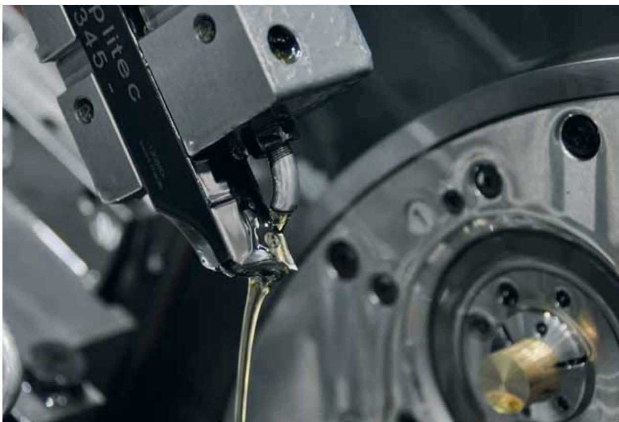
Le porte-outil de la Tornos MultiSwiss 6x14 comporte désormais un trou d'amenée du liquide de coupe qui est dirigé avec précision jusqu'au point le plus avancé: entre le tranchant de l'outil et la pièce à usiner.
