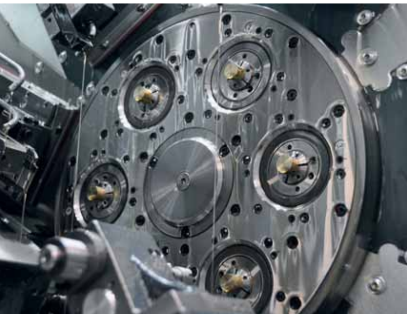
Il cuore della macchina: la zona di lavorazione con 6 fantine mobili. Grazie al concetto pluriutensili, è possibile montare sulla macchina sino a 18 diversi utensili.
