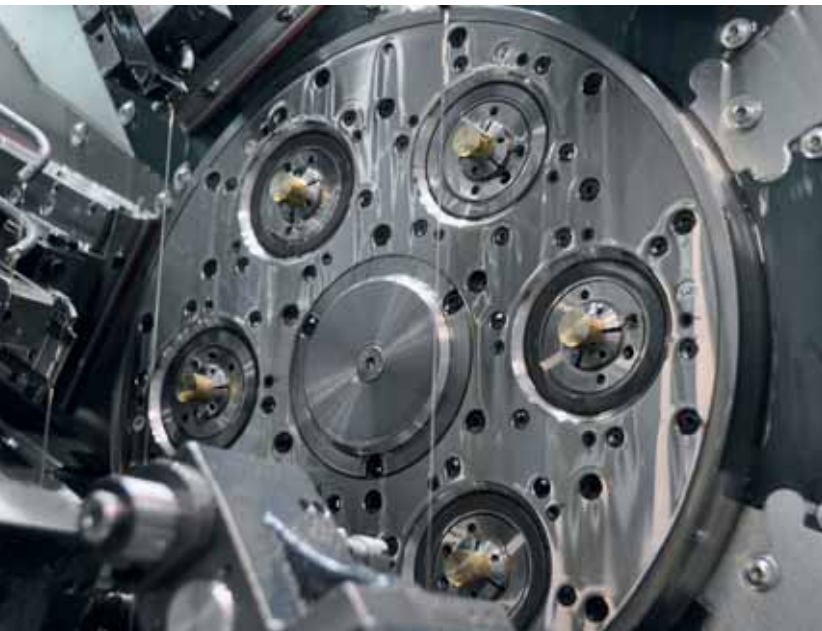
Maskinens hjärta: Bearbetningsområdet med sina 6 rörliga spindeldockor. Tack vare konceptet med multiverktyg kan upp till 18 olika verktyg monteras i maskinen.
