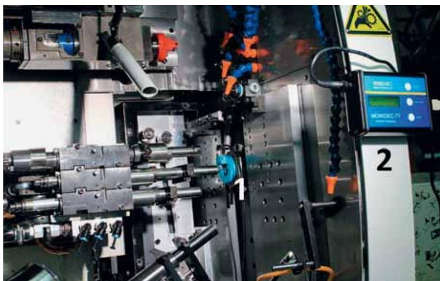
Mowidec-TT wird auf einer Deco 10-Maschine von Tornos eingesetzt: 1) Sondenträger-Ring und 2) Kontrolleinheit. Das Kabel, mit dem die Sonde mit der Kontrolleinheit verbunden ist, kann im Bearbeitungsbereich problemlos eingesetzt werden.
