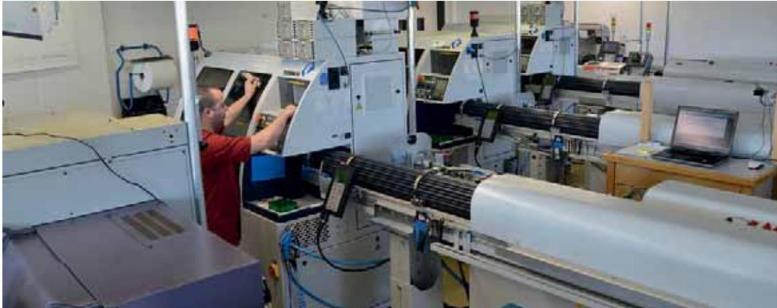
In der Werkstatt der Deco 10 arbeiten die Maschinen 18 Stunden pro Tag und 6 Tage die Woche in einer kontrollierten Umgebung. Toleranzbereiche von +/- 2 µ sind hier üblich.
