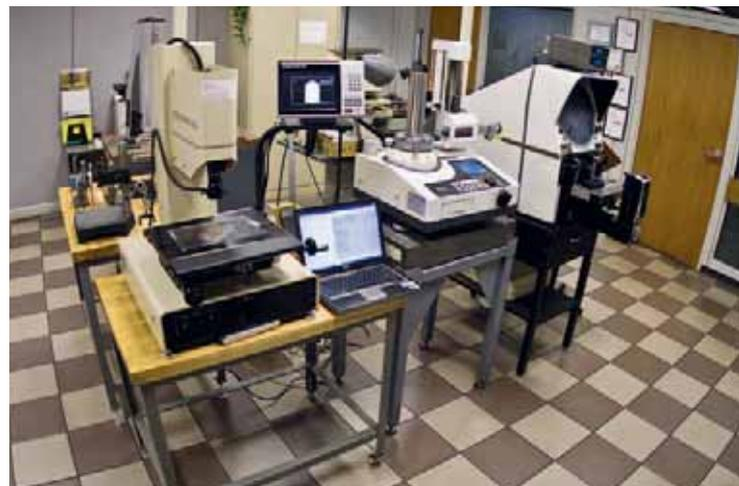
DuAll verfügt über schnelle optische Abtastgeräte zur Qualitätssicherung der Werkstücke, die DuAll mit hoher Produktivität und extremer Präzision auf den Drehautomaten von Tornos aus der Schweiz herstellt.
