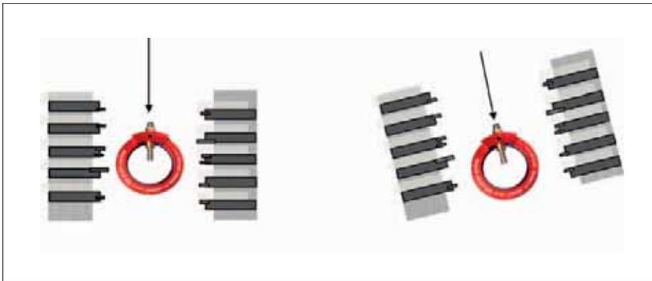
Posizionamento alla bussola. L'asse verticale della sonda deve essere posizionato nello stesso piano dell'asse verticale di spostamento dei pettini.
