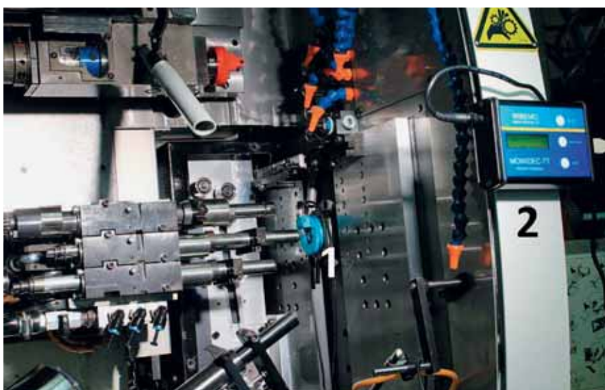
Mowidec-TT installerad på en Tornos Deco 10: 1) sensor-lagerring och 2) kontrollenhet. Kabeln som ansluter sensorn till enheten tål atmosfären i bearbetningsområdet utan problem.
