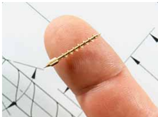
这个用于铜制纺织机上的长1.5厘米的高精度喷嘴轴，是在Tornos Deco 2000机床上紧接着一系列不锈钢零件后被加工完成的，它们同样使用的是Ortho NF-X切削油。
