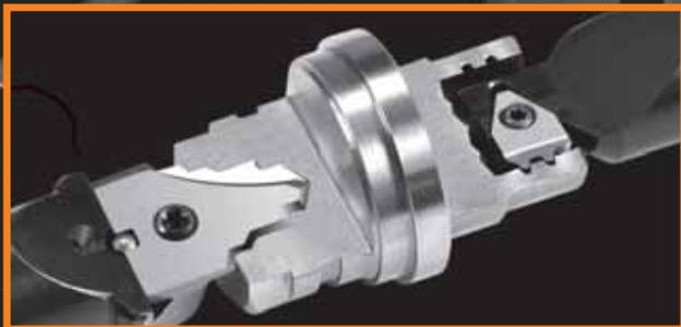
Sistema ad alto rendimento con inserti intercambiabili Schwanog lappati singolarmente.
