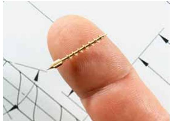
Questo albero di alta precisione, lungo 1,5 cm, destinato ad un polverizzatore per macchine tessili, è in ottone ed è stato realizzato su una Tornos Deco 2000 a cui, subito dopo, ha fatto seguito una serie di particolari in inox, con un solo e medesimo olio da taglio (Ortho NF-X).
