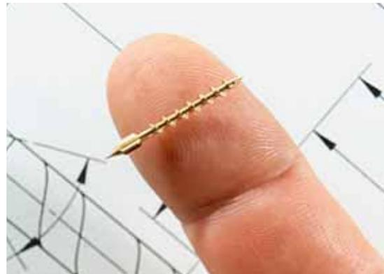
Este eixo de atomizador de alta precisão com aproximadamente 1,5 cm de comprimento para uma máquina têxtil de bronze foi fabricado logo após uma série de peças de inox com o mesmo óleo de corte (Ortho NF-X) em uma Tornos Deco 2000.
