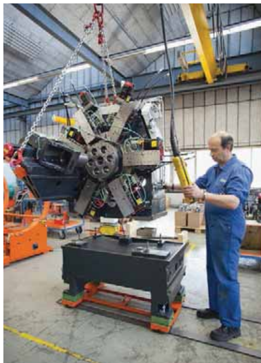
此处，在装配过程中多主轴模块与铸铁底盘结合在一起。总的来说，Tornos MultiSwiss 是制造机械和电气加工的杰作。
