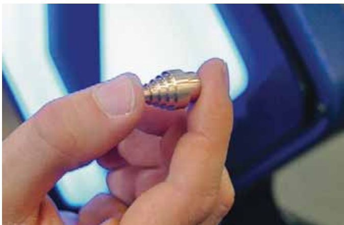
在每台新机床上都有各种各样的测试部件在有限的几个生产运行中加工制造出来，之后进行精确测量。
