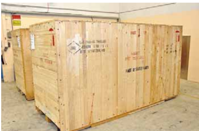
在机床运行正常，并已获得客户确认后，排除切削油，Tornos 再次进行分拆以便运输。包装牢固后，即可发往客户处。
