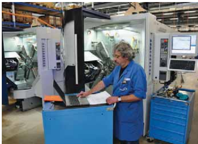
此处，专家正在对一台 Tornos MultiSwiss 6x14 的几何特性进行测试。如果不使用计算机和专门开发的软件，这将是不可能的。
