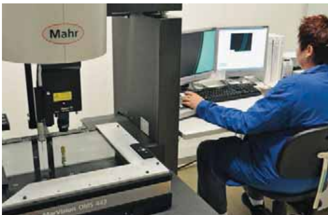
采用高精度的测量工具对制造的零部件进行测量并记录。因此，有问题的机床可以以绝对精度进行调整。
