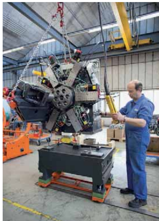
Hier wird in der Montage der Mehrspindelblock mit dem Chassis aus Spezialguss „verheiratet“. Generell ist die Herstellung einer Tornos MultiSwiss aus mechanischer und elektrischer Sicht eine Meisterleistung.
