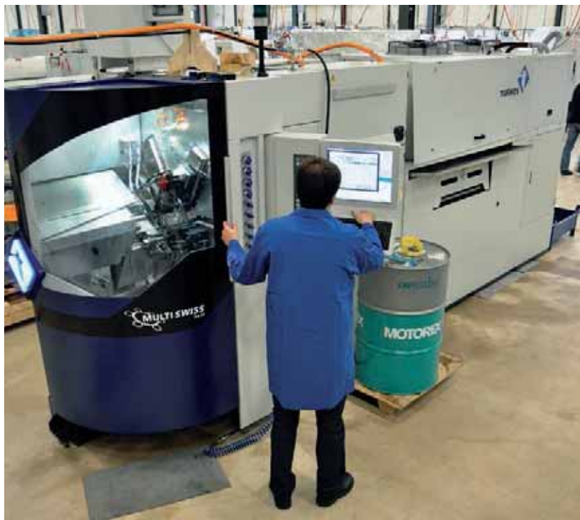
La messa in servizio richiede un elevato numero di tappe per il posizionamento ed il controllo. Successivamente, la macchina viene sottoposta ad un rodaggio nel corso di un processo perfettamente definito.
