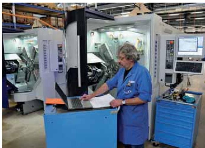
Aqui, o profissional verifica a geometria de uma MultiSwiss 6x14 da Tornos. Sem um computador e um software especialmente desenvolvidos, isto não poderia ser realizado.
