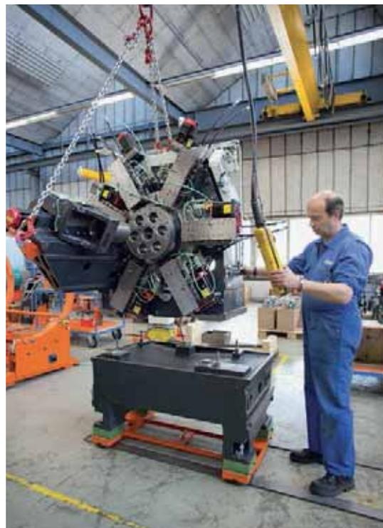
Na montagem, o bloco de fuso múltiplo é "casado" com o chassi de fundição especial. No geral, a fabricação de uma MultiSwiss da Tornos é uma obra-prima do ponto de vista mecânico e elétrico.
