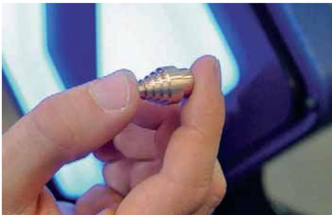
Várias séries pequenas das mais diversas peças de teste são fabricadas em cada máquina nova e precisamente mensuradas.
