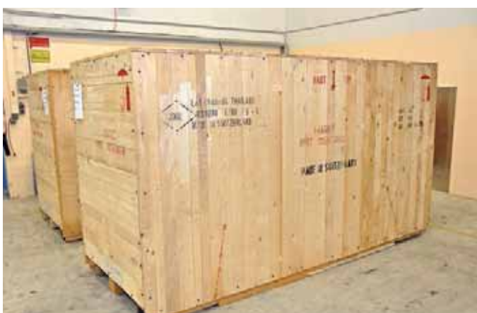
Efter att maskinen blivit driftsklar och godkänts sugs skäroljan ur och Tornos-maskinen demonteras delvis för transport. Väl emballerad är den nu klar för leverans till kunden.
