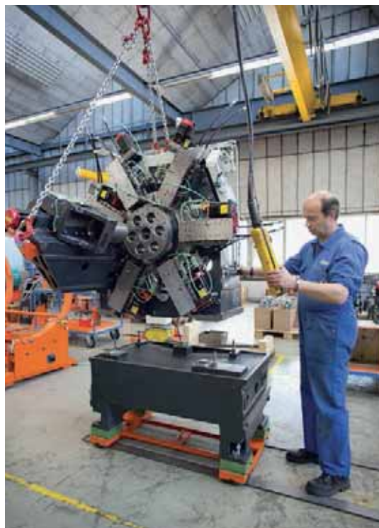
Här "gifter sig" flerspindelblocket med underredet av gjutjärn under monteringen. I stort sett är tillverkningen av en Tornos MultiSwiss ett mekaniskt och elektriskt kraftprov.
