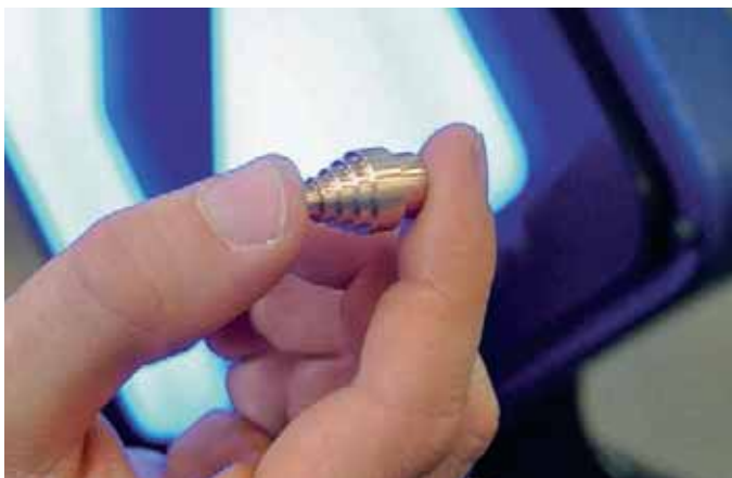
Ett flertal snäva produktionskörningar av en bred variation av testdetaljer tillverkas i varje ny maskin och mäts sedan upp exakt.
