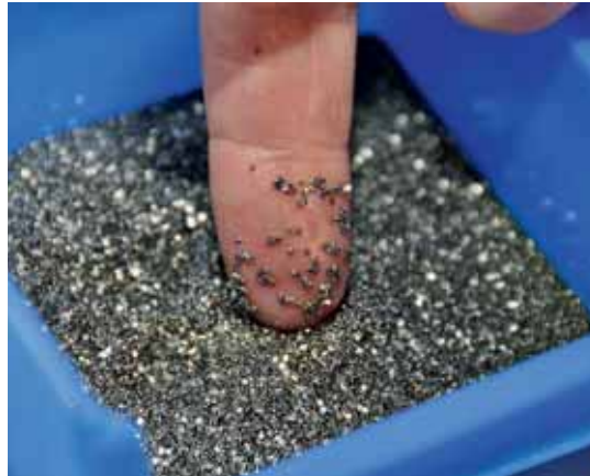
Von blossen Auge sind viele Präzisionsdrehteile für die Uhrenindustrie wie diese nur 1,19 mm langen Schrauben für mechanische Uhrwerke kaum zu erkennen.
