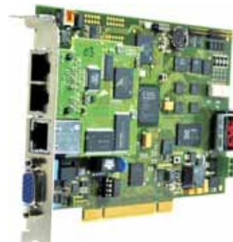
CTM V6 – Optimal mit der Maschine vernetzte Prozessüberwachung
