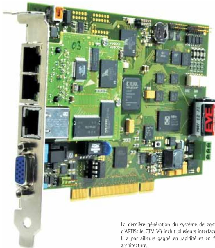
La dernière génération du système de contrôle de processus et d'outils d'ARTIS: le CTM V6 inclut plusieurs interfaces, parmi lesquelles l'Ethernet. Il a par ailleurs gagné en rapidité et en flexibilité grâce à sa nouvelle architecture.
