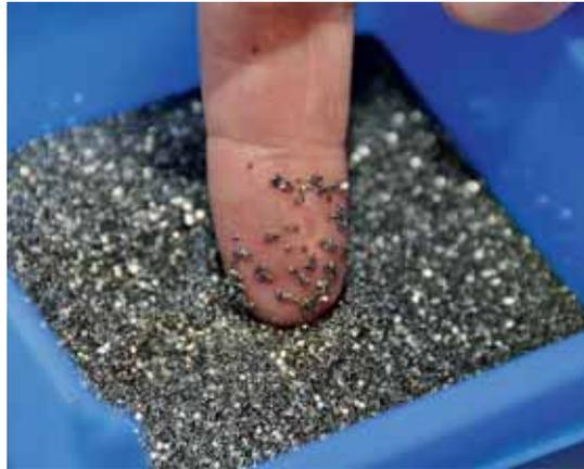
A l'œil nu, il est presque impossible de faire la distinction entre les nombreuses pièces de précision destinées à l'horlogerie, telles que des vis d'une longueur de 1,19 mm destinées à des mouvements mécaniques.
