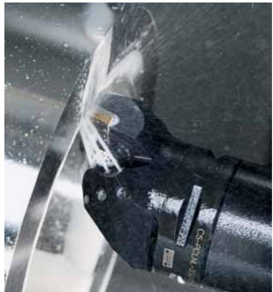
améliore considérablement le positionnement des arêtes de coupe, la sécurité des process et la facilité du changement de l'outil en machine, ainsi que le temps nécessaire à cette opération. Une action de coupe tangentielle régulière est nécessaire pour garantir la précision élevée et la qualité des états de surface qui sont nécessaires tout au long du process.
