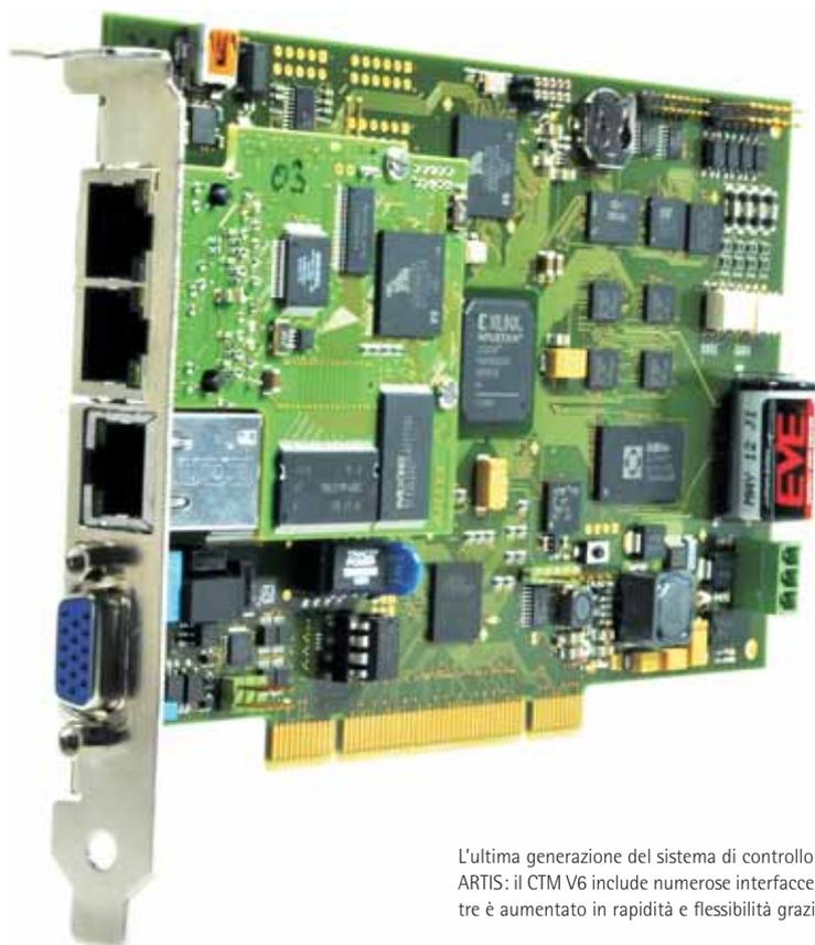
L'ultima generazione del sistema di controllo dei processi e degli utensili di ARTIS: il CTM V6 include numerose interfacce, tra le quali l'Ethernet ed inoltre è aumentato in rapidità e flessibilità grazie alla sua nuova architettura.
