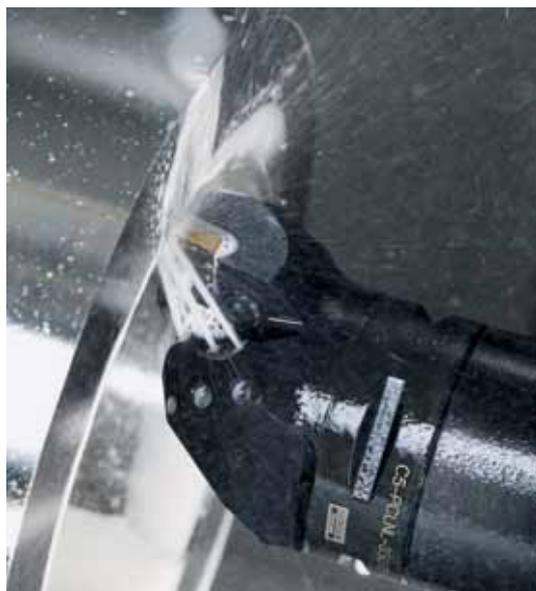
di turbofilettatura ha consentito di soddisfare pienamente questi requisiti. L'utensile può essere sostituito direttamente in macchina. Inoltre, un'azione di taglio tangenziale particolarmente leggera assicura elevati livelli di precisione e finitura superficiale richiesti in tutto il processo.
