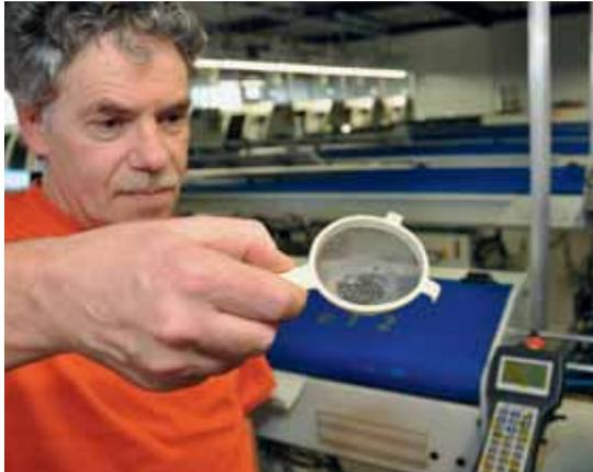
Aqui, um dos controladores de qualidade da Easydec retira uma amostra dos parafusos a serem medidos em uma das máquinas.
