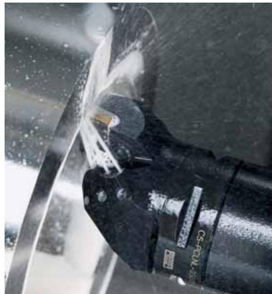
de troca da ferramenta na máquina. Uma ação de corte tangencial suave é necessária para assegurar a alta precisão e o acabamento superficial exigido em todo o processo.
