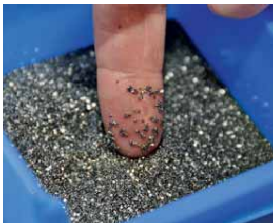
Många precisionssvarvade detaljer för klocktillverkning, såsom dessa skruvar för urverk, som är bara 1,19 mm långa, är knappt synliga med blotta ögat.
