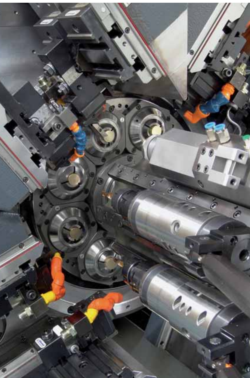
MultiSigmas bearbetningsutrymme. Verktygen är driftsäkert övervakade med ARTIS och processerna är därmed tryggade.
