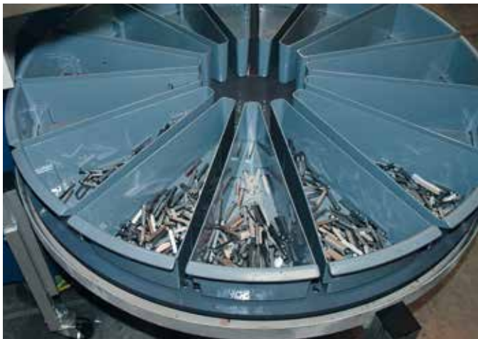
隶属“性能设计”方面的零件圆盘传送带，由十五段同等长度的冲针共同构成一个完整的Rhin-o-Tuff冲针组。
