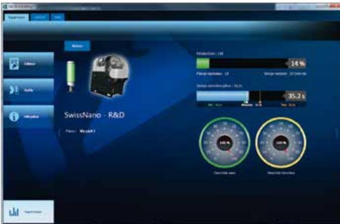
Detailliertes Monitoring einer Maschine in Echtzeit und Überwachung des Produktionszustandes. Auch beispielsweise die verwendete Werkstückzeichnung kann abgerufen werden.
