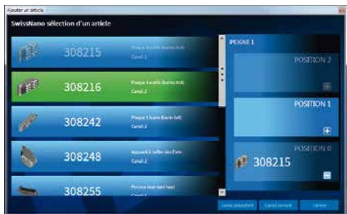
Auswahl eines Apparats auf der SwissNano: Nicht verfügbare Apparate werden in Grau, bereits installierte Apparate in Dunkelblau angezeigt. Die Anwender sind sich einig: einfach genial!
