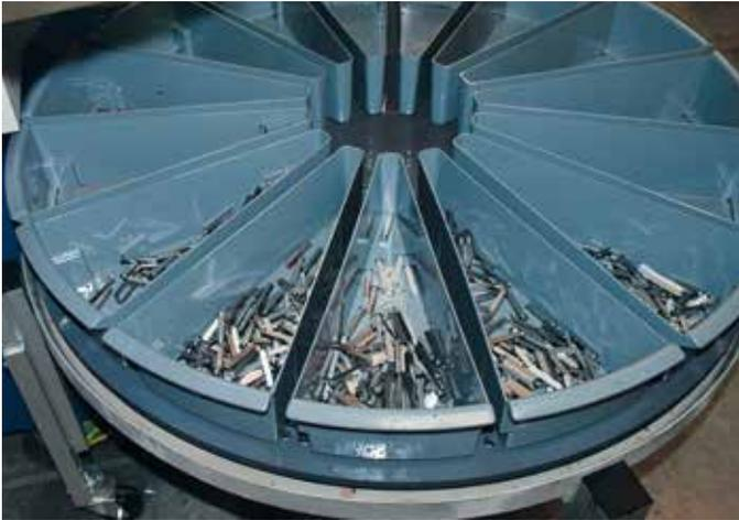
Das Teilekarussell von Performance Design mit fünfzehn Aufnahmen fasst einen kompletten Rhin-o-Tuff-Stempelsatz (ein Stempelsatz besteht aus fünfzehn gleichen Stempeln unterschiedlicher Länge).
