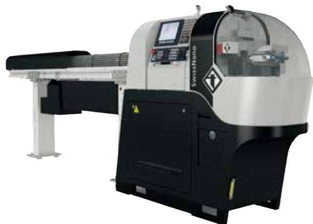
Die SwissNano-Familie erhält ausserdem mit der Almac BA 1008 Zuwachs. Dabei handelt es sich um eine von der Firma Almac auf Basis der SwissNano entwickelte Stangenfräsmaschine speziell für die Herstellung komplexer Teile, die zahlreiche Fräsvorgänge erfordern (siehe der Artikel auf Seite 14).
