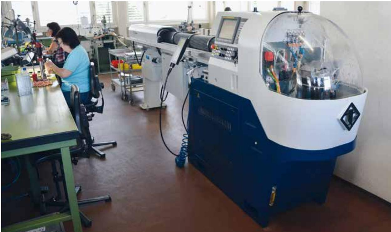
Dadas las necesidades de la prueba, se instaló la máquina SwissNano fuera del taller de mecanizado. Sus reducidas dimensiones y su diseño permiten instalarla en cualquier taller. Como no hay ningún acceso por detrás, puede instalarse incluso contra la pared.
