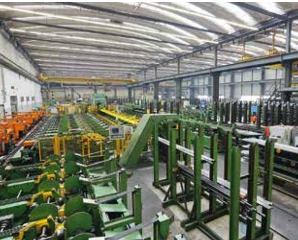
Su un impianto di produzione in continuo, gli acciai HSX® sono, a seconda delle esigenze, trafilati, scrostati e rettificati.
