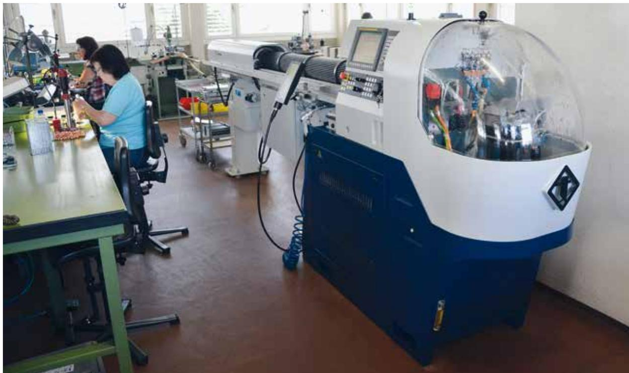
Per le necessità necessarie al test, la macchina SwissNano è stata installata al di fuori dell'officina di tornitura. Il suo ridotto ingombro e il suo concetto le consentono di trovare il proprio spazio in qualsiasi officina. Poiché non c'è accesso nella parte posteriore, questa macchina può essere collocata anche contro un muro.
