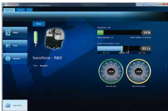
Detaljerad övervakning av en maskin i realtid och övervakning av produktionsstatus. Ritningen för den aktuella detaljen kan till exempel också visas.
