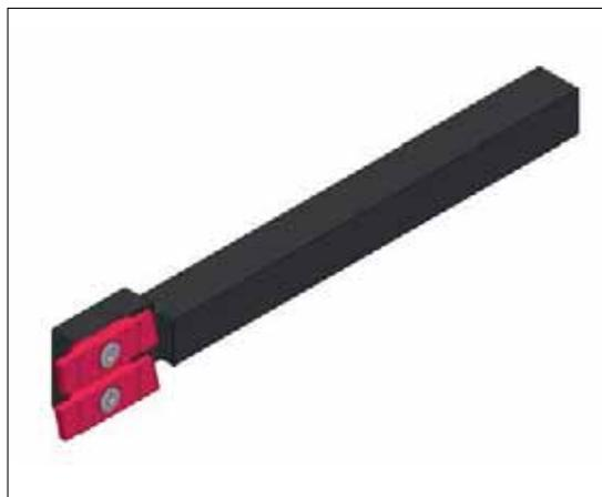
Der Vorteil dieses Werkzeugsystems ist, dass die Originalkonfiguration erhalten bleibt und der Dreher gleichzeitig an einer Position den Doppelwerkzeughalter und an den anderen Positionen seine Standardwerkzeuge (geschweißt, PKD, Wendepplatten aller Arten) benutzen kann.
