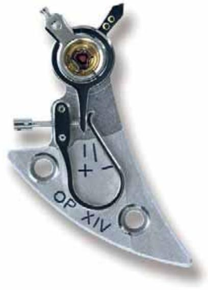
Die Schwingung der Spiralfeder wird über ihre wirkungsvolle Länge definiert. Damit lässt sich der Rhythmus des Ganges regulieren. Alle Befestigungsteile (Spiralklötzchen mit Spiralklötzchenträger) und Regulierungsteile (Stift, Rückerschlüssel und Rucker) bilden die Feinregulierung.
