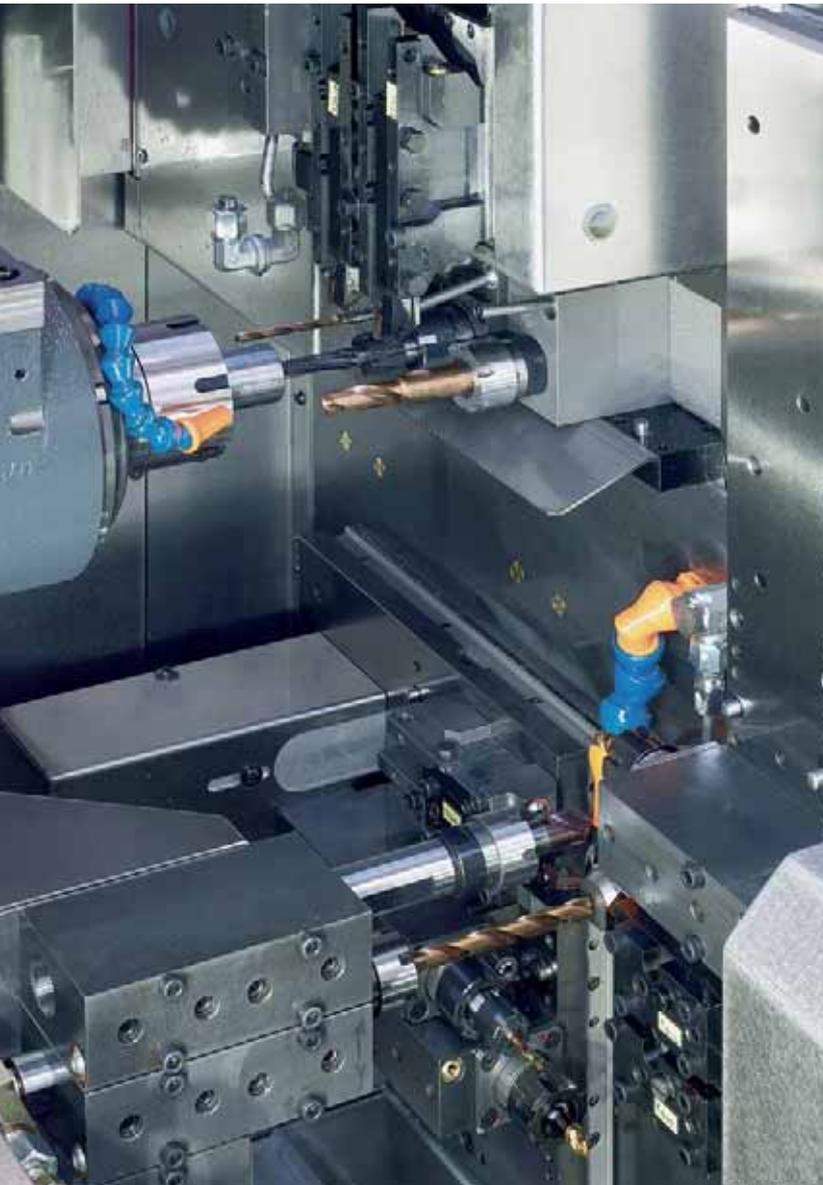
categoría. El resultado se nota en el mecanizado: La EvoDeco 32 trabaja con unas condiciones de corte comparables a las de un cabezal fijo. Los husillos no presentan ninguna dificultad pese a trabajar con cargas importantes y gracias al par constante pierden muy poca o nada de velocidad de rotación.
