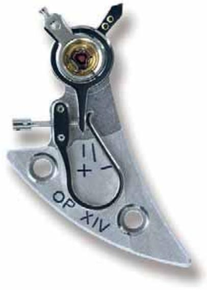
Las oscilaciones de la espiral se definen en toda su longitud efectiva. Estas permiten regular el ritmo de funcionamiento. Todas las piezas de fijación (pitón con portapitón) y los órganos reguladores (pasador, llave de raqueta y raqueta) intervienen en el ajuste de precisión.
