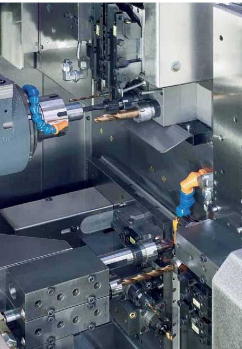
l'usinage: EvoDeco 32 travaille avec des conditions de coupe comparables à la poupée fixe. Les broches ne montrent aucune difficulté, malgré les charges importantes, et grâce au couple constant, elles ne perdent pas ou très peu de vitesse de rotation.
