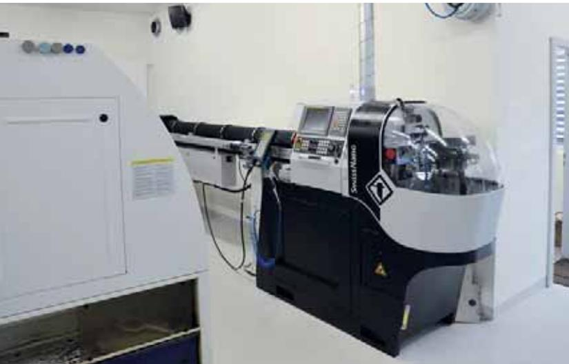
L'encombrement de la machine SwissNano permet de la placer dans des locaux relativement exigus.
