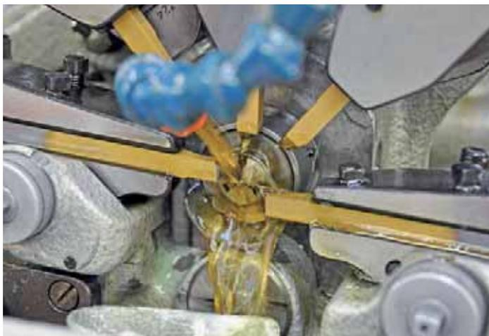
Le choix du fluide d'usinage utilisé se répercute directement sur la productivité et la durée de vie des outils.
