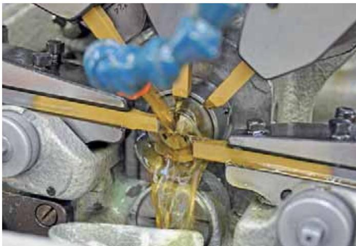
La scelta del fluido di lavorazione che viene utilizzato, si ripercuote direttamente sulla produttività e sulla durata di vita degli utensili.
