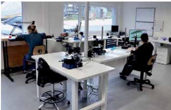
L'azienda è attrezzata per i controlli dimensionali e visivi e, in funzione delle necessità, procede a un controllo al 100% della sua produzione.
