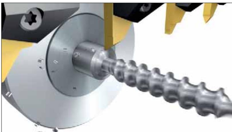
Como os parafusos para ossos são componentes de titânio longos e delgados, o processo de usinagem de roscas precisa ser especialmente seguro e eficiente para produzir um componente de alta qualidade. O turbilhonamento de roscas é ideal porque é um processo produtivo e confiável e evita a deflexão e a tendência às vibrações. A escolha correta das ferramentas, dos dados de corte, da programação e do ajuste do processo é importante para obtenção de resultados otimizados, com produtividade superior.
