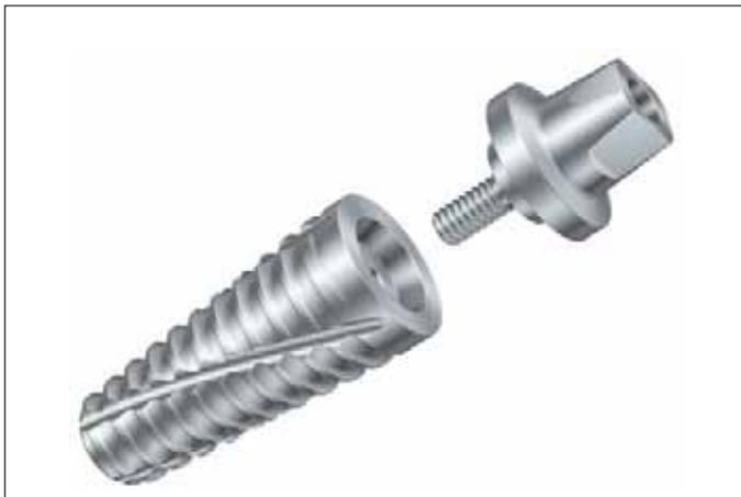
Para ter uma produção competitiva, o torneamento externo de parafusos odontológicos deve ser planejado para ser um processo altamente eficiente, seguro e consistente que supere qualquer problema com a vida útil ou velocidade da ferramenta. O formato, a geometria, a classe da pastilha, bem como os dados de corte são os principais fatores de otimização.
