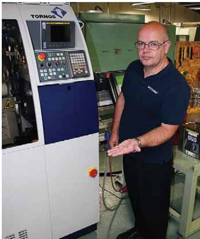
站在Deco 10a前面的Steve Somers手持一个2 mm长的铜喷嘴，这种铜嘴每星期的产量达到30,000个。
