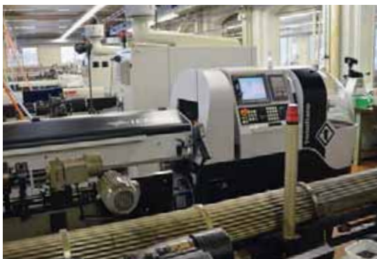
SwissNano 机床和 lemca 棒料进给装置的占地面积很小。厂长计划安装具有 2m 棒料机的机床，以增加机床安装数量。
