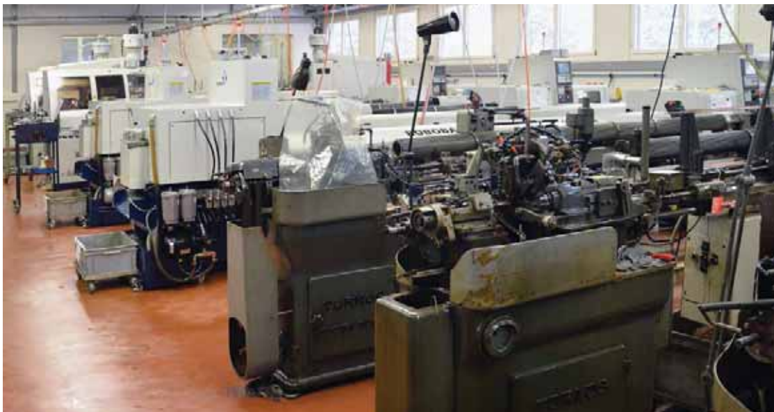
Ultra 车间有许多不同的机床，这意味着可以选择最佳的零件制造机床。对于不足一周的交货期，SwissNano 已经替换了既有的凸轮式机床。
