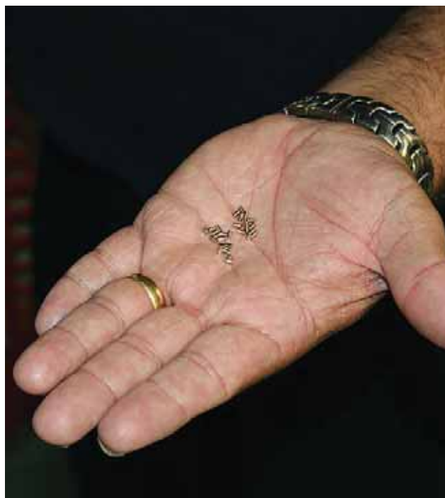
特写镜头：Steve Somers正将一个2 mm长的黄铜喷嘴安装到高速主轴上
