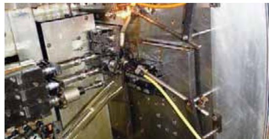
Deco 10 beim Schneiden eines Steckerkontakts.
