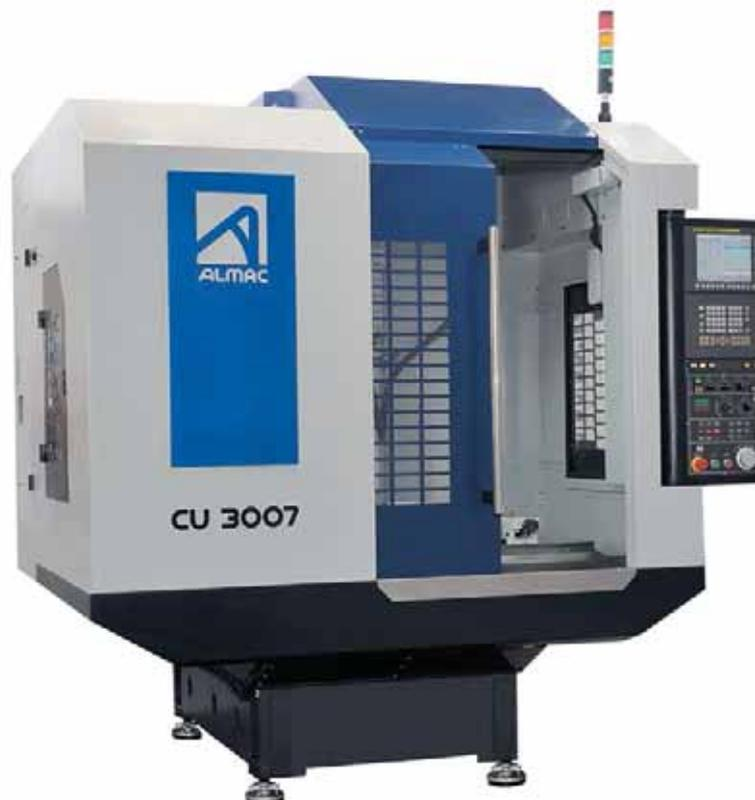
male Drehzahl von 20000 U/min ist schnell erreicht und sie verfügt über ein großes Drehmoment von 11,8 Nm sowie eine Leistung von 2,2/3,7 kW (S1/ S3). Optional können die CU 2007 und die C 3007 dank der technischen Kompetenz von Almac sogar mit noch leistungsfähigeren Spindeln mit bis zu 40000 U/min ausgerüstet werden. Almac hat immer das Ohr am Markt und findet für jeden Kunden die optimale Bearbeitungslösung.
