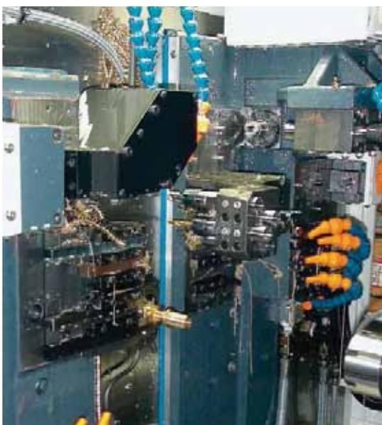
Swiss ST 26 bei der Herstellung eines Steckergehäuses.
