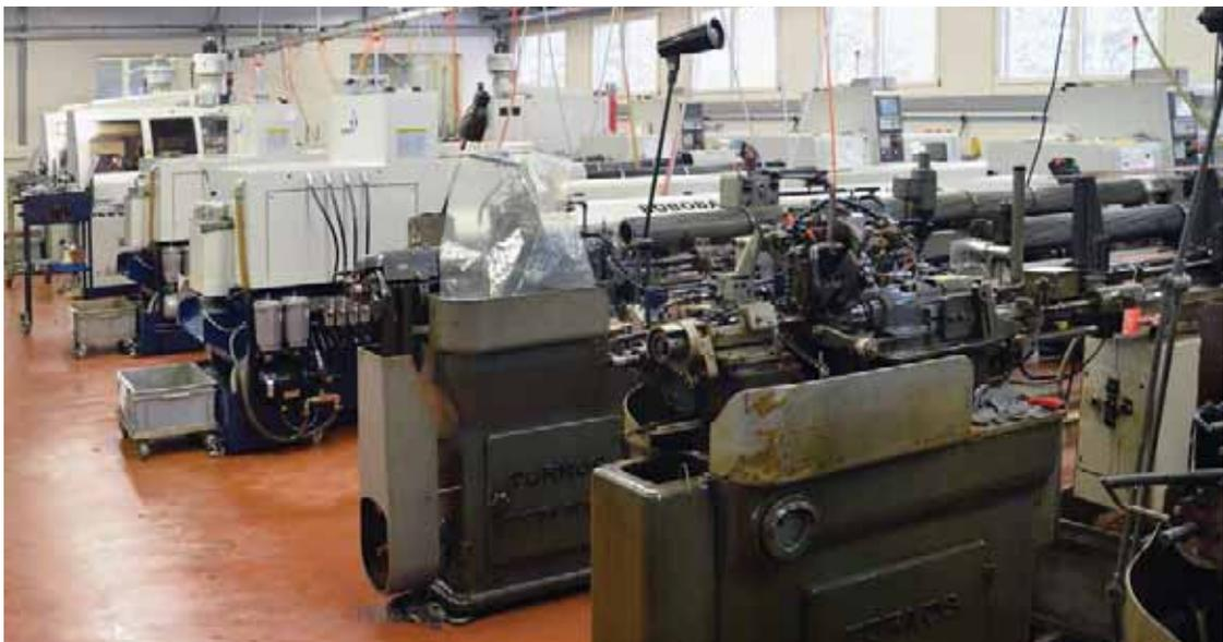
El taller Ultra cuenta con numerosas máquinas diferentes que le permiten elegir siempre bien el medio de producción necesario respecto a la pieza que se va a realizar. Para unos tiempos de producción inferiores a una semana, SwissNano ha sustituido la máquina de levas.
