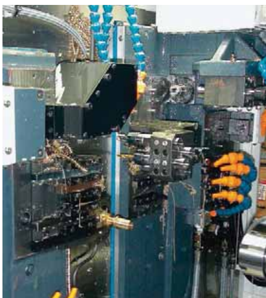
La Swiss ST 26 intenta a realizzare un corpo connettore.
