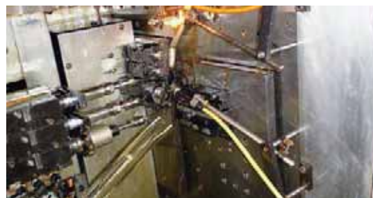
La Deco 10 intenta a segare un contatto per connettore.
