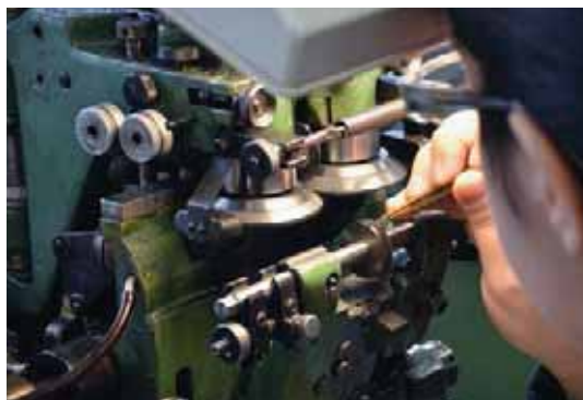
L'azienda possiede un'ampia officina di filiere a rulli per filetti che le permette di consegnare ai suoi clienti particolari perfettamente ultimati.
