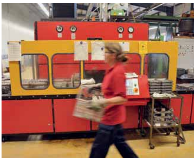
Antes da medição automática, as peças são lavadas na eficiente linha de lavagem. Aproximadamente 10 colaboradores da RB-Cema dedicam os seus conhecimentos e habilidades ao serviço aos clientes.
