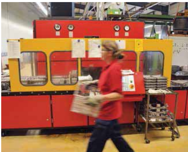
在自动清洗步骤前，先要在功率强大的清洗槽中清洗部件。在RB-Cema公司，大约十名员工利用自身知识和技能为客户服务。
