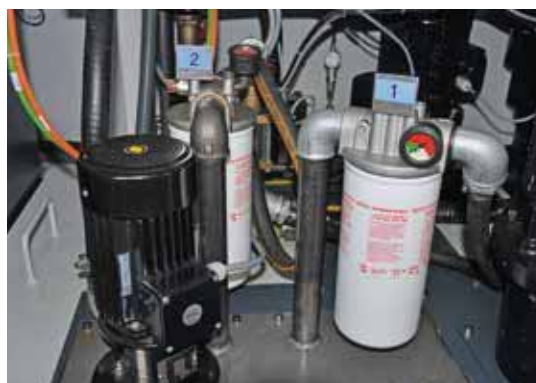
MultiSwiss 6x14 机床配置了一个锥形过滤器，还有多个内部过滤器，可以过滤细度为5 \mu 的油。这对液压安装的6轴机床特别重要。
