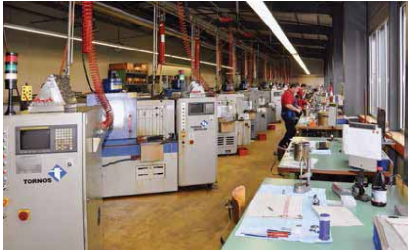
Biberist工厂的生产车间里，全天有效地进行部件加工。在RB-Cema公司的生产中，专门采用Tornos的多轴机床。
