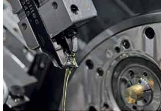
Motorex Ortho NF-X eignet sich bestens für alle bei RB-Cema eingesetzten Mehrspindler. Die Tornos MultiSwiss 6x14 wurde mit Ortho NF-X entwickelt und nutzt das Schneidöl in den verschiedensten Funktionen.
