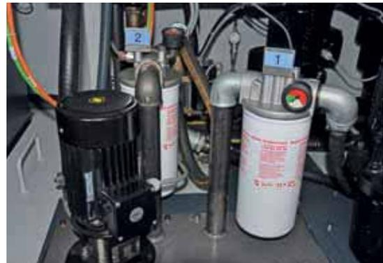
Neben einem Bandfilter besitzt die MultiSwiss 6x14 auch mehrere interne Filter, welche das Öl bis auf 5µ fein filtern. Dies ist besonders für die hydrostatische Lagerung der 6 Spindeln zentral.
