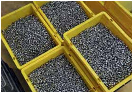
Die Qualität wird durch die dokumentierte Prüfung aller Produktionschargen sichtbar gemacht. Neben der Masse wird auch z.B. die Oberflächenqualität (Rz-Wert = Welligkeit und Rauheit) bestimmt.
