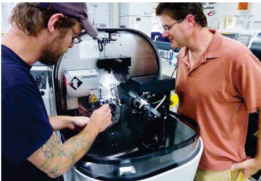
数控经理和工厂经理正在一台新的SwissNanos机床上安装7度角规，以便加工用于医疗和电子行业的定制部件。
